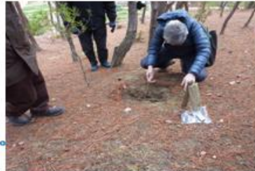
温度計で地中10cmの計測
